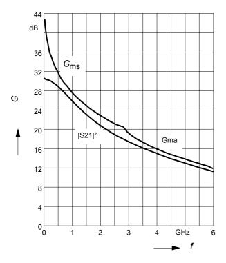
Power gain  $G_{ma}$ ,  $G_{ms} = f(V_{CE})$   $I_{C} = 20 \text{ mA}$ f = parameter in GHz
